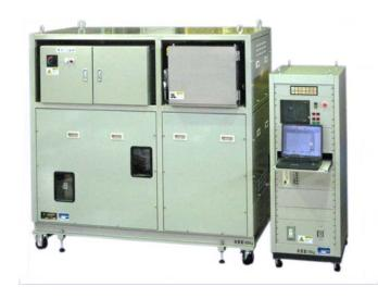
圧力印加のメカニズムは、サーボバルブで制御されたブース タシリンダにより衝撃圧を印加する方式で高速の昇圧速度を 得ています。制御系は圧力センサーの信号をフィードバック に用いていることで、高精度かつ高速の制御系を実現しまし た。圧力媒体には水を使用しているため、槽内の清掃が容易 です。
