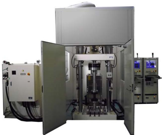
本装置は、4本支柱の門型フレームのクロスヘッド中央にサーボアクチュエータを配した恒温槽付の疲労試験です。電気—油圧サーボにより変位制御で取付位置の調整を行い、荷重制御で疲労試験を行います。また、一定荷重試験や位置決め制御試験も可能です。
