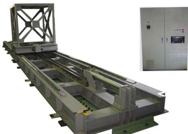
自動車が車線変更等をする時に、ドライバーが体感する横加速度を再現する等のことが出来る直線運動装置です。
