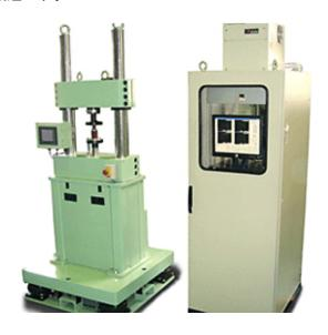
エンジンマウントの生産工程で、動特性試験をおこなう装置。本体フレーム、加振装置、試験項目等を大幅に簡素化することで、ローコスト化を実現、生産ラインに導入しやすくなりました。静バネ試験1種、動バネ試験3種の合計4種類の試験の、実施・解析・合否判定までを自動で行うことができる。データはコントローラ内のパソコンに保存できます。 本体に装着されたタッチパネルにより、生産機種や検査パターンを選択することが可能。
