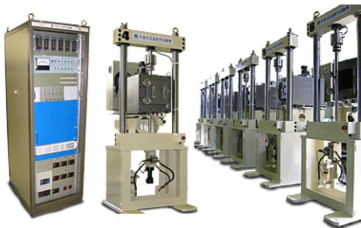
装置は供試体に一定温度下で繰り返し荷重を加え、疲労試験を行ないます。制御系には電気・油圧サーボ弁を使用し、供試品にかかる荷重をコントロールする荷重制御系を構成しています。最大6台の試験機をコントロールすることができ、各試験機本体には恒温槽が取り付け、指定された一定の温度を維持しながら連続的に荷重を印加します。6台の試験機は、コントローラからの信号により、荷重の振幅、オフセット、周波数が制御されます。周波数は6台全ての試験機で共通ですが、振幅及びオフセットは試験機毎に別の値をセットすることが可能です。試験の経過及び試験データは、ディスプレイに表示されると共に、ハードディスクに記録されます。
