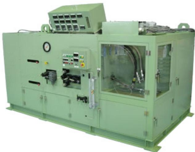
航空機部品の油圧試験をするテストスタンドの例。
