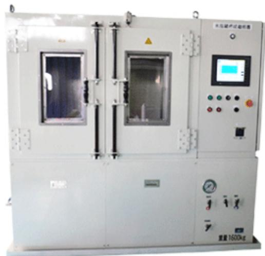
ACサーボモーターで油圧ポンプの回転速度と方向を制御するパワーマイスターを使用してブースタシリンダを駆動し、供試体に内圧を加えて破壊圧力を計測する装置です。扉に窓があるため、試験中の供試体の様子を観察しながら試験を行えます。試験データを計測・記録し、パソコンへ読み出すことが可能です。タッチパネルで目標圧力と昇圧速度を設定しますので、試験条件設定が容易にできます。また、タッチパネルに現在圧力、ピーク圧力を表示しますので試験中、試験終了後の圧力も確認できます。
