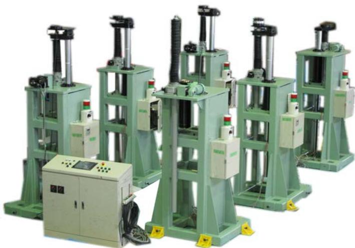
6本の支柱で航空機の胴体を支え、サーボモータの制御により支柱の高さを同時に同期しながら昇降させます。それぞれの支柱の上部には計量用のロードセルが取り付けられており、合計することで機体重量を計量します。
