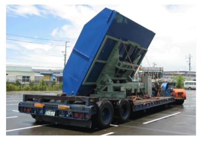
写真は、直径5mのH-2Bタンクドームを運搬する際に製作したもの。傾斜するだけでなく、上下左右に稼動することで、車幅を狭くし、バランスを取って走行することが可能。
