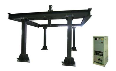
各軸の移動は、電動サーボモータ駆動のボールスクリューに より行います。
